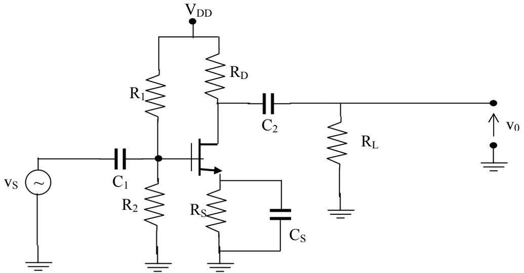
$V_{DD}=10\text{ V}$ ;  $R_1=R_2=10\text{k}$ ;  $R_L=6$ ;  $V_t=1$ ;  $k=0,5$ ;
